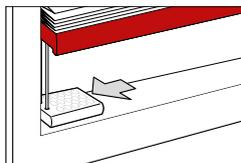
8 In feuchtem, geschlossenem Zustand wieder in die Träger einhängen.
