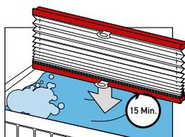
4 Nach 15 Min. Einweichzeit die Plisseo®-Anlage entfalten. Bei DUETTE®-Stoffen sofort das Wasser aus den Waben laufen lassen.
