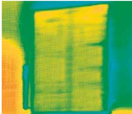
Mit Rollläden: geringer Wärmeverlust
